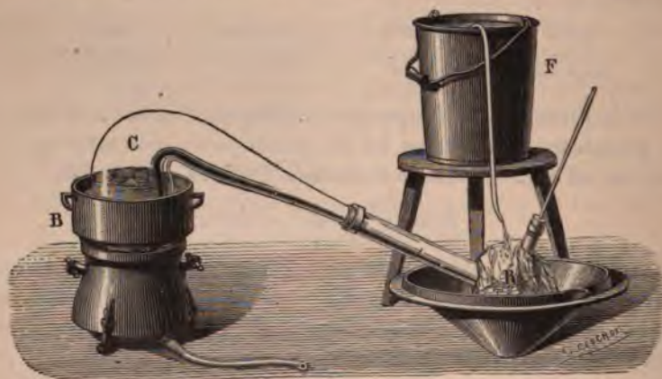
Fig. 150. — Préparation de l'acide phosphorique.
